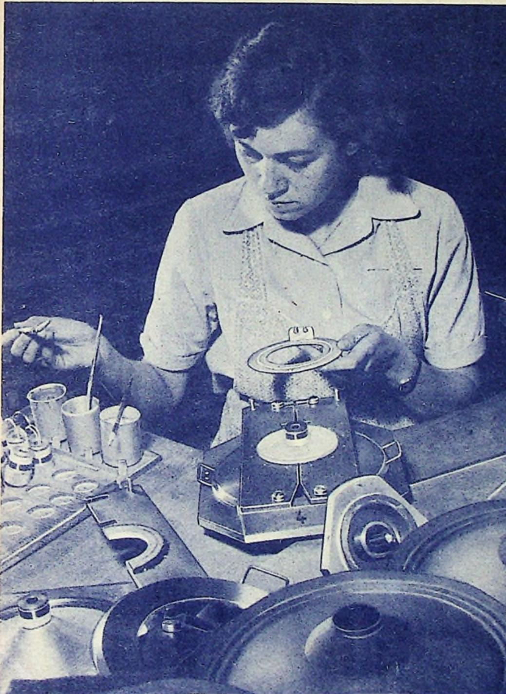
Bei den Geräten der neuen Saison wird der Klangqualität und damit den Lautsprechern ganz besondere Aufmerksamkeit gewidmet. Hier ein Bild aus der Fertigung der Lorenz-Celophon-Lautsprecher. Genau gearbeitete Spannvorrichtungen sorgen für einwandfreie Zentrierung sowohl beim Verkleben der leichten Schwingspule mit der elliptisch gekrümmten Membran als auch beim Aufsetzen der Gewebezentriermembran und ihrer ringförmigen Halterung.
