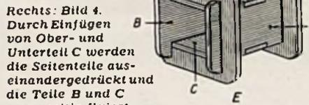
Rechts: Bild 4. Durch Einfügen von Ober- und Unterteil C werden die Seitenteile auseinandergedrückt und die Teile B und C gegenseitig fixiert
