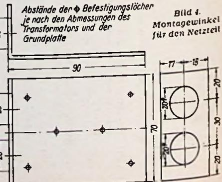
Bild 4. Montagewinkel für den Netzteil
